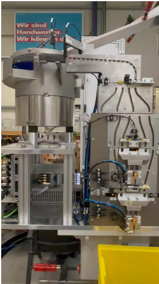
Einlegeteilbereitstellung mit Steilförderer und Multiplexer
