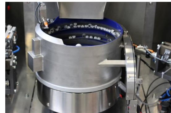
Wendelförderer mit Auslaufwendebogen
